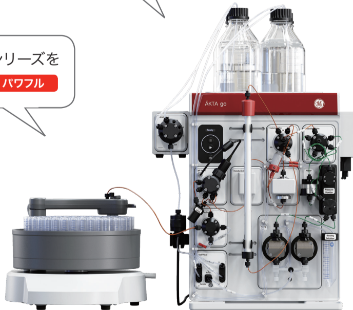
pHモニターとカラムバルブ、インジェクションバルブを増設した構成
