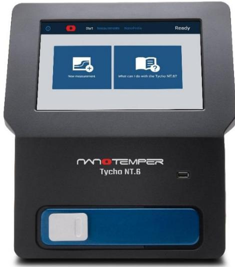
Tycho はタンパク質の立体構造状態を短時間で評価します。35~95℃の範囲を 30℃/分の速度で加温し、その間に検出される蛍光(330nm と 350nm)を測定します。加温によりタンパク質の立体構造が崩れ、内在していたトリプトファンとチロシン残基が表面化します。これにより生じる蛍光比率(350/330nm)の変化をプロットし、サンプルの立体構造状態として評価します。標準サンプルをリファレンスとし、リファレンスとの差から状態を判断します。
