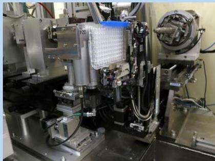
結晶が析出した結晶化プレートを直接マウントすることで、結晶本来の回折能を評価できるようになりました。
