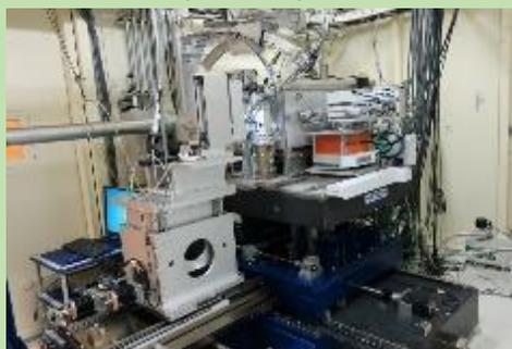
タンパク質結晶の回折測定で使用される波長よりも、さらに短い波長での回折測定を行うことで、通常の波長で同定できない種類の重金属原子を結晶構造中で検出したり、超高分解能の回折データの測定が可能です（右は回折写真の例）。
