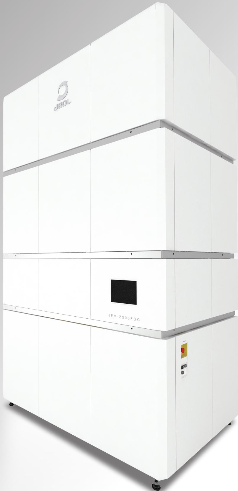
CRYO ARM™ 300 (JEM-Z300FSC) は冷陰極電界放出形電子銃、インカラム形エネルギーフィルター(オメガフィルター)、サイドエントリー液体窒素冷却ステージ、ならびに自動試料交換機構を装備した生体高分子をクライオ温度で観察できる電子顕微鏡です。自動試料交換機構内に最大12個の試料を保管することができます。保管中の試料は1個、または複数個取り外しおよび交換ができるので、柔軟に測定のスケジュールが行えます。また、新設計のオメガフィルターとホールフリー位相板を組み合わせることで、生物系試料のさらなるコントラスト向上が可能となります。
