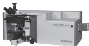
顕微レーザーラマン分光測定装置 LabRAM HR Evolution
