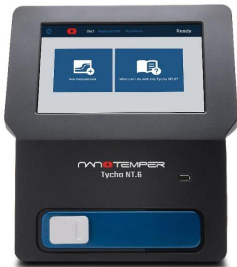
Tycho はタンパク質の立体構造状態を短時間で評価します。35~95℃の範囲を 30℃/分の速度で加熱し、その間に検出される蛍光(330nm と 350nm)を測定します。加熱によりタンパク質の立体構造が崩れ、内在していたトリプトファンとチロシン残基が表面化します。これにより生じる蛍光比率(350/330nm)の変化をプロットし、サンプルの立体構造状態として評価します。標準サンプルをリファレンスとし、リファレンスとの差から状態を判断します。
