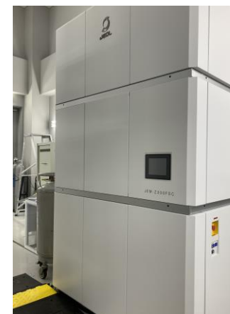
EM02CT JEOL CRYO ARM 200 (JEM-Z200FSC) ・ Cold FEG 200 kV運用 ・ インカラムΩフィルター ・ ガタン K2 summit ・ 自動画像取得ソフト JADAS（日本電子）、SerialEM ・ ホールフリー位相板
