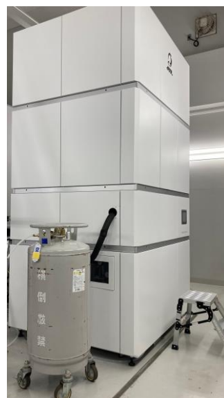
EM01CT JEOL CRYO ARM 300 (JEM-Z300FSC) ・ Cold FEG 300 kV運用 ・ インカラムΩフィルター ・ ガタン K3 ・ 自動画像取得ソフト JADAS（日本電子）、SerialEM ・ ホールフリー位相板
