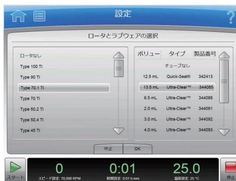
ロータカタログ、チューブカタログが標準搭載。最高回転数を自動判定して、回転数設定ミスによるチューブ破損を予防
