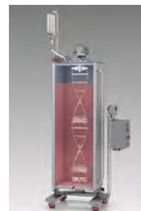
攪拌時間、入力容量 (power to input volume; PIV) およびkLaパフォーマンスは、近年の細胞培養工程用 (>1x10<sup>8</sup>細胞数/mL) に最適化
