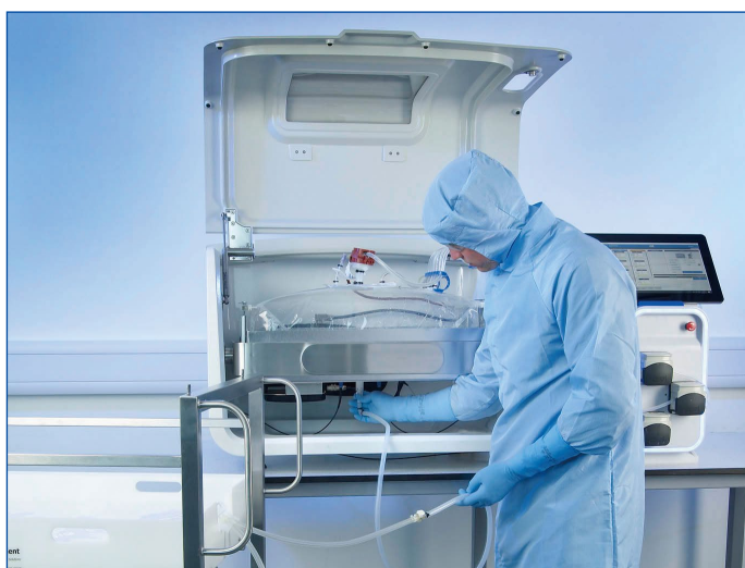
一体型ドレインによる回収操作の単純化
